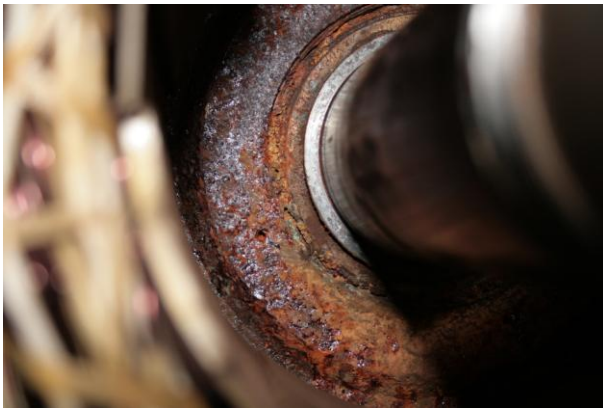
Abb. 10: Stark korrodiertes DE-seitiges Rillenkugellager
