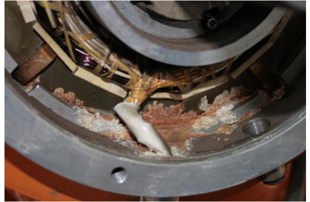
Abb. 7: Korrosionsspuren am DE-seitigen Lagerstatorblechpaket infolge Wassereintritts
