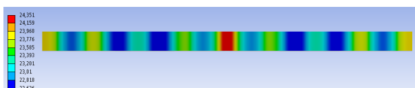
Abbildung 10: Temperaturverteilung auf der Oberseite des Spulengehäuses
