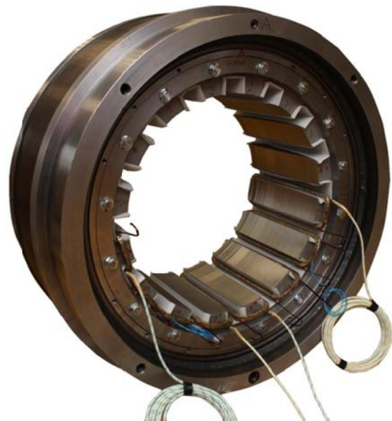
Bild 10: Stator der mechanischen Belastungseinrichtung
