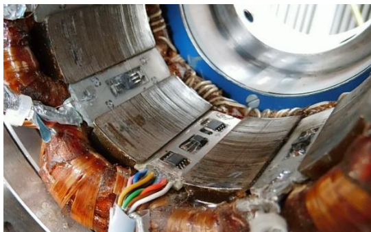
Fig. 2 Streuflusssensoren im eingebauten Zustand
