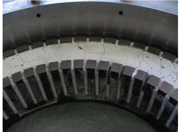
Abb. 4: Axialmagnetlager mit keramischer Isolation
