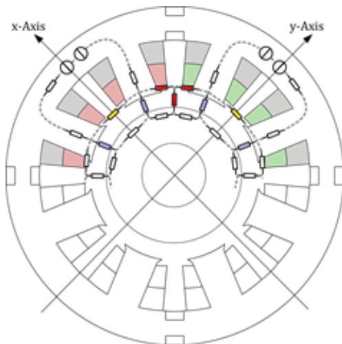
Abbildung 1 Netzwerk aus magnetischen Widerständen zur Veranschaulichung von Magnetflüssen in Magnetlagern am Beispiel eines Heteropolarlagers. Intrapolare Streuflüsse sind gelb, interpolare Streuflüsse rot und der Luftspaltfluss blau dargestellt.
