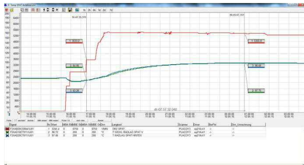
Bild 7: Traglagertemperaturen beim Anfahrvorgang
