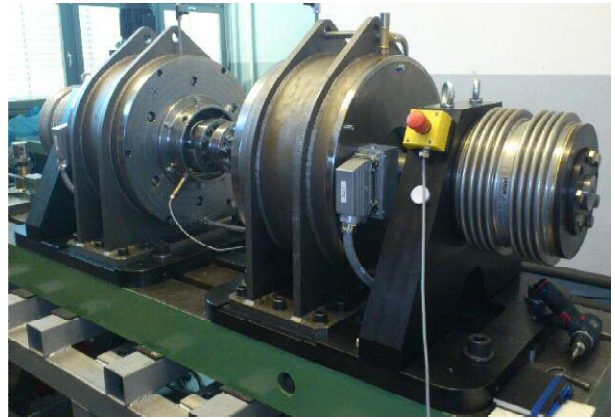
Fig. 6: Umlaufbiegeprüfstand mit Magnetlagern als Aktuator
