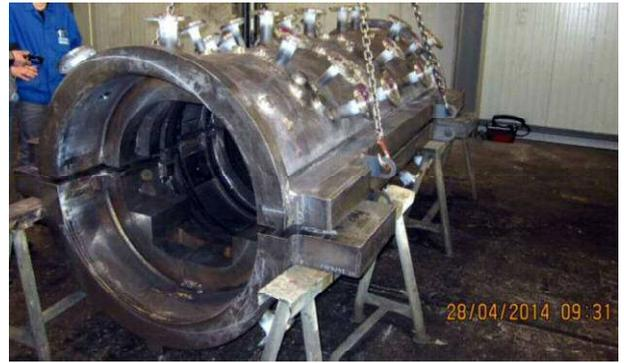
Fig. 5: Druckfester Rezipient mit angeschweißten Flanschen
