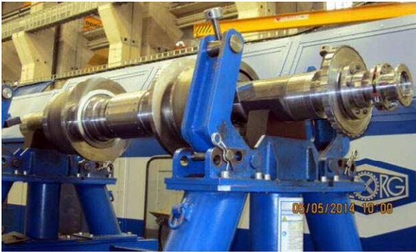
Fig. 4: Einbaufertig montierter Rotor
