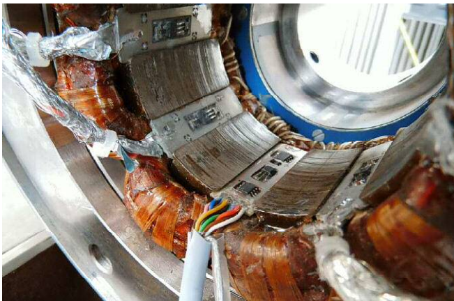
Abbildung 2. Im Versuchslager eingebaute Sensoren.
