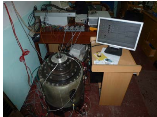
Fig.8 rig of AMB flywheel rotor system
