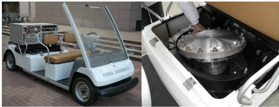
Fig. 1 Overview of AMB Flywheel Powered EV
