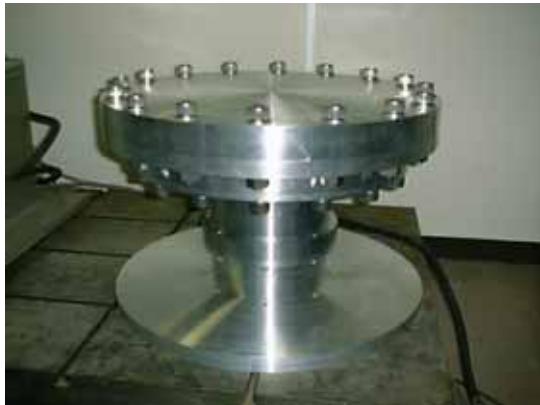
Figure 9: Overview of AMB flywheel rotor system
